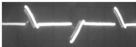
Рис. 3. Осциллограмма выходного напряжения силового блока: а – скачки напряжения по амплитуде, б – пропуски полупериодов.
