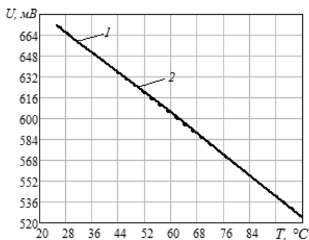
Рис.1. Зависимость от температуры прямого напряжения на p-n -переходе при малом измерительном токе; 1 – кристалл; 2 – корпус
