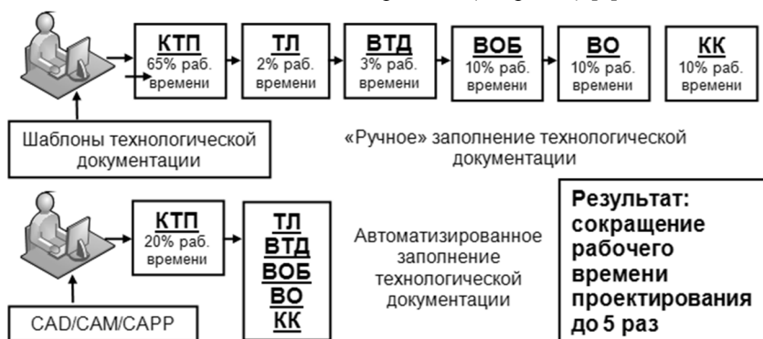
Рис. 1. Сопоставление различных способов технологического проектирования КТП – карта технологического процесса, ТЛ – титульный лист, ВТД – ведомость технологической документации, ВОБ – ведомость оборудования, ВО – ведомость оснастки, КК – комплектовочная карта
