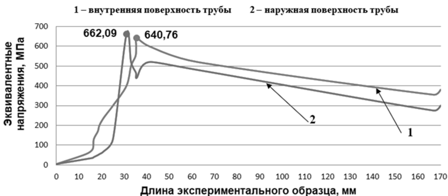
Рис. 4. Поле эквивалентных напряжений для модели, выполненной СТ
