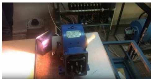
Рисунок 3 – Экспериментальные исследования электромагнитного вытягивания электрической дуги
