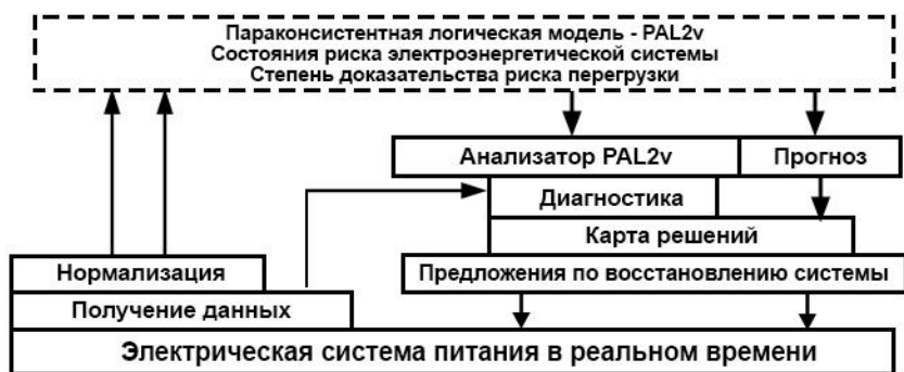
Рисунок 1 – Параконсистентная логическая модель, состоящая из степеней свидетельств риска, полученных на основе значений тока и напряжения в реальной электроэнергетической системе.
