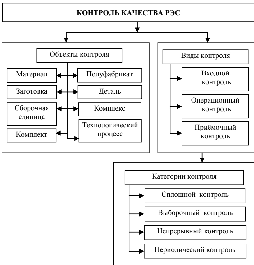
Рис. 3.12. Контроль качества РЭС
